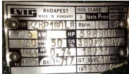
2. ábra: ATEX irányelv előtt telepített robbanásbiztos kivitelű motor adattáblája
